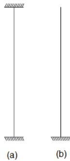
A relação entre a carga crítica de Euler para flambagem da coluna (a) e a carga crítica da coluna (b) vale:
